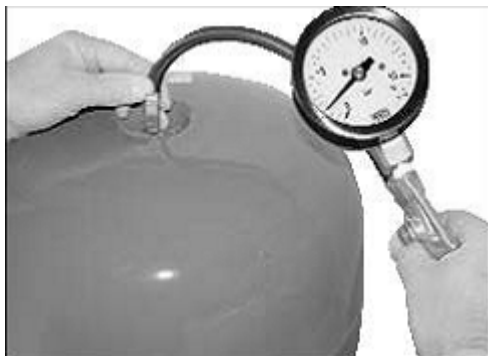
Рис. 6 Контроль давления в мембранном баке
