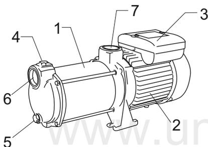
Насос состоит из гидравлической части (1), асинхронного электродвигателя (2) и блока подключения с пусковым конденсатором (3). Насос имеет
