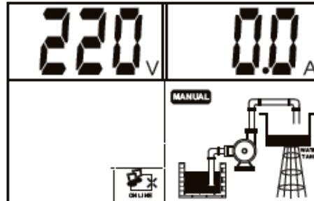
**Примечание: Параметры калибровки насоса В аналогичны параметрам калибровки насоса А, просто в ходе настройки нужно нажать кнопку **B START** вместо **A START****
