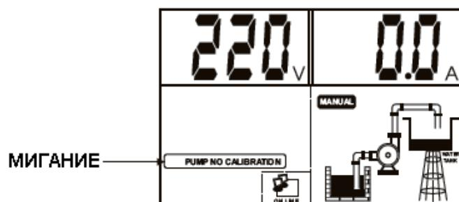
**Примечание: Удаление параметров калибровки насоса В аналогична удалению параметров калибровки насоса А, просто в ходе настройки нужно нажать кнопку **B START** вместо **A START****
