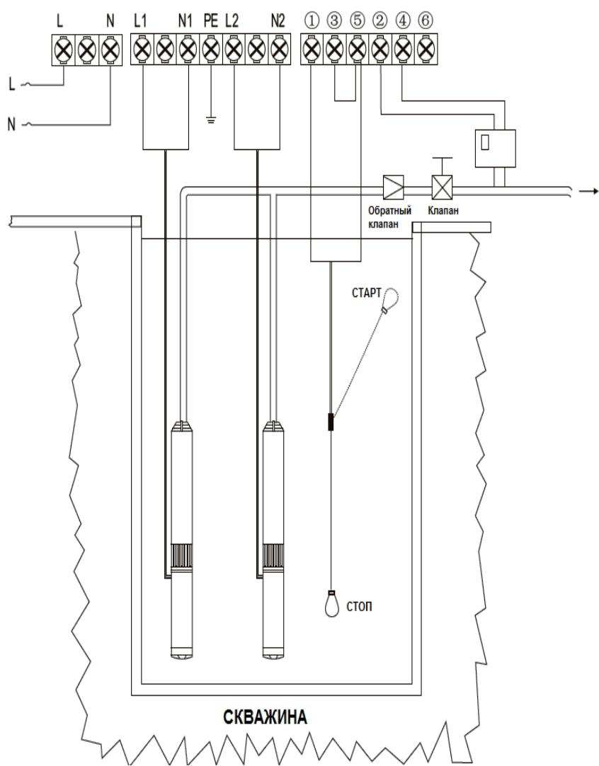
**Примечание №1:** Настройки давления на реле давления В должны быть выше настроек давления на реле давления А.
